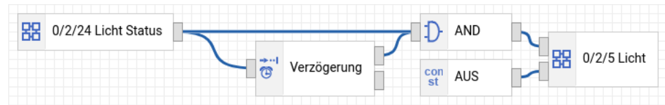
Abbildung 11: Einfache Lichtautomatik
